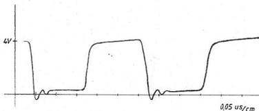
Wenn Sie ein einfaches Oszilloskop haben, kann die Kurve sägezahnförmig ausfallen, das liegt daran, daß 4MHz schon erhebliche Anforderungen an die Bandbreite eines Oszilloskops stellt, unterhalb 30 MHz wird's da kritisch.
