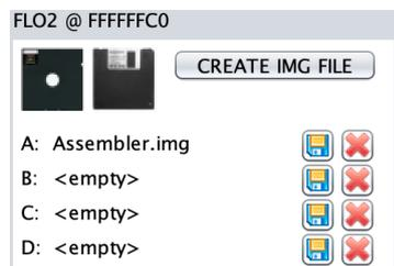
Mit dem Treiber FLO2 können insgesamt vier Diskettenlaufwerke emuliert werden. Welche Formate erkannt werden hängt dabei natürlich von der Implementierung innerhalb der betriebenen Software ab. Um das Arbeiten mit dem Emulator einfacher zu gestalten, können leere Diskettenimages im Standard-Format des NKC direkt über die Oberfläche erstellt werden.
