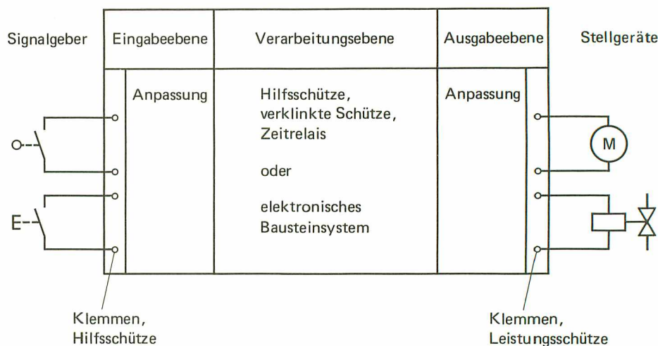
Bild A 4.1 Blockschema einer VPS (VPS = verbindungsprogrammierte Steuerung).
