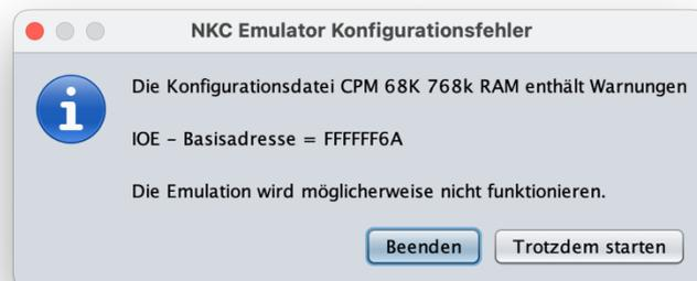
Bei Konfigurationsfehlern, zum Beispiel mehrfache Definition gleicher Baugruppen, wird eine entsprechende Meldung angezeigt und die Emulation kann nicht gestartet werden. In diesem Fall muss die Konfiguration korrigiert werden.
