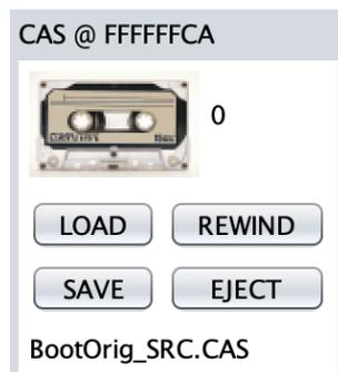
Der Treiber für die Baugruppe CAS emuliert das Kassetteninterface des NKC und verwaltet einen Daten-Puffer unbestimmter Größe. In diesem Puffer werden alle an den Baustein 6850 der Baugruppe CAS übertragenen Bytes gesichert beziehungsweise von dort geladen.
