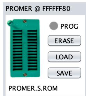
Der Treiber für die Baugruppe PROMER ist auf die übliche Konfiguration für 8 kByte EPROMS des Typs 2764 eingestellt. EPROMS können gelesen, programmiert und gelöscht werden. Die Bedienung der Baugruppe erfolgt über den Frame im Hauptfenster.
