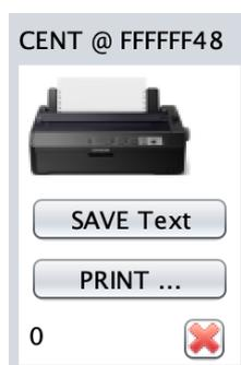
Der Treiber für die Baugruppe CENT emuliert das Druckerinterface des NKC und erlaubt das Ausdrucken sowie das Speichern aller an die Baugruppe gesendeten Daten. Der Treiber enthält einen Puffer, in dem alle gesendeten Daten gesammelt werden. In der unteren linken Ecke wird der Füllstand des Puffers angezeigt.
