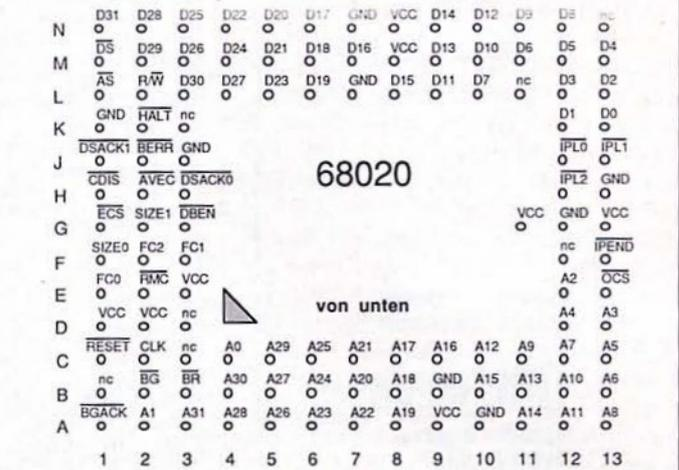
Bild 20. Die CPU-Pin-Belegung
