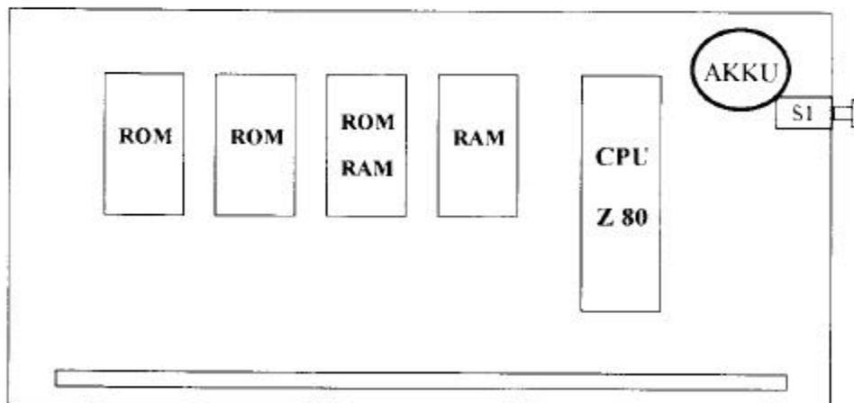
Hinweis: Die SBC3-Baugruppe ist hardwaremäßig identisch zu der SBC3-Baugruppe des Grundgerätes, jedoch ist der Speicherinhalt des EPROM's (Monitorprogramm) unterschiedlich.
